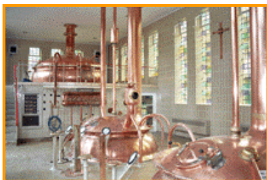
Calderas de macerado en un proceso industrial.
